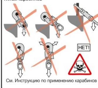
Рис. 9. Использование на горизонтальных и наклонных поверхностях
