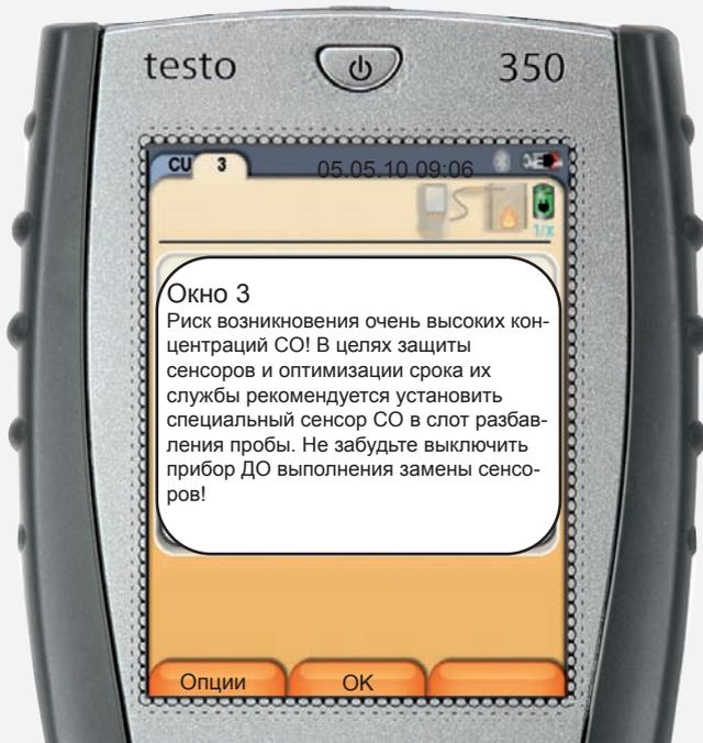
Пример использования функции диагностики управляющего модуля, сопровождающейся выводом соответствующей информации на дисплей (открытый текст)
