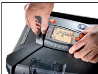
Управляющий модуль просто “защелкивается” в блок анализатора
