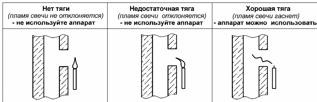
Рисунок 4. Способ проверки тяги в дымоходе
