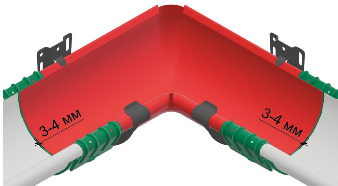
Рис. 16 Установка угловых элементов
