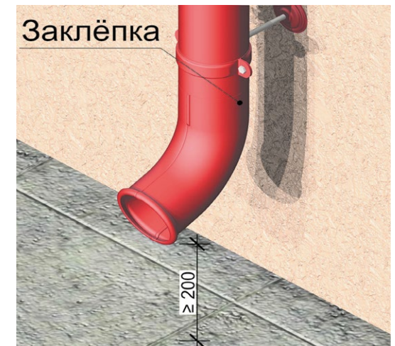
Рис. 21 Установка отвода трубы
