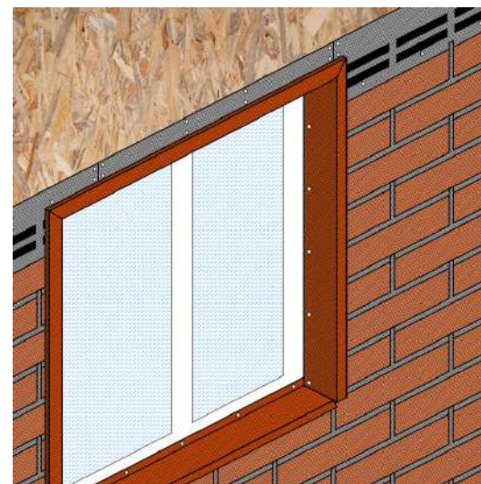
Рис. 33. Монтаж фасадной плитки над окном на наличник 3D с посыпкой (тип 5, таблица №2).
