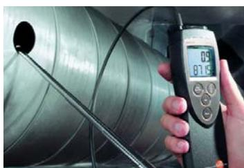
Термоанемометр **testo 425\*\***
