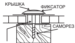
КРЕПЛЕНИЕ С ПОМОЩЬЮ Н-ПРОФИЛЯ И ТЕРМОШАЙБ
