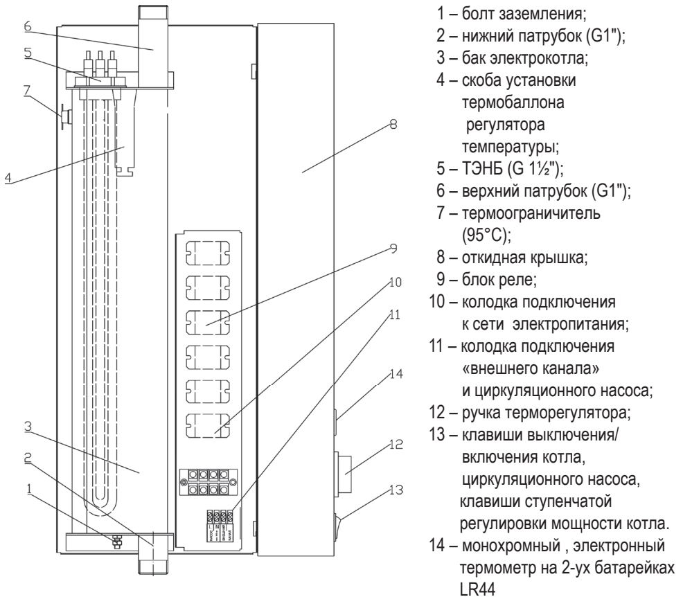
Рис. 1. Устройство электрокотла (крышка открыта).
