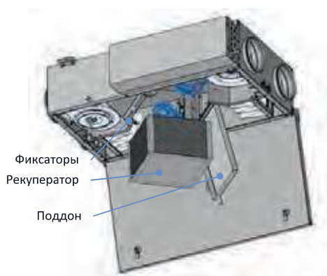
Рис. 31. Обслуживание рекуператора на UniMAX-P 450/800 CE-A
