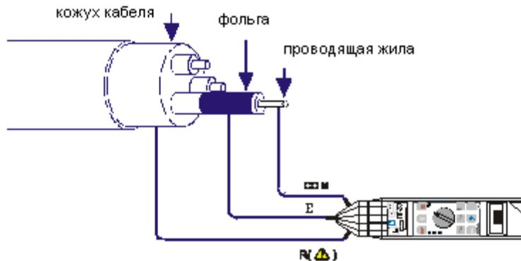
Рис.7 Измерение сопротивления изоляции кабеля методом тройного зажима
