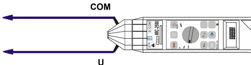
Рис. 9 Измерение напряжения переменного тока
