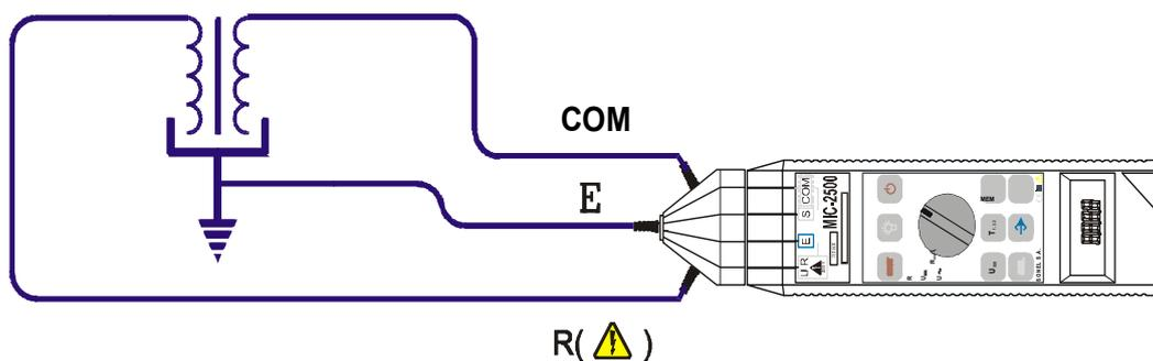
Рис.6 Измерение сопротивления изоляции трансформатора методом тройного зажима
