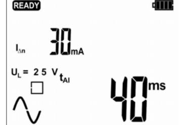
Время  $t_{AI}$  протекания тока срабатывания  $I_A$
