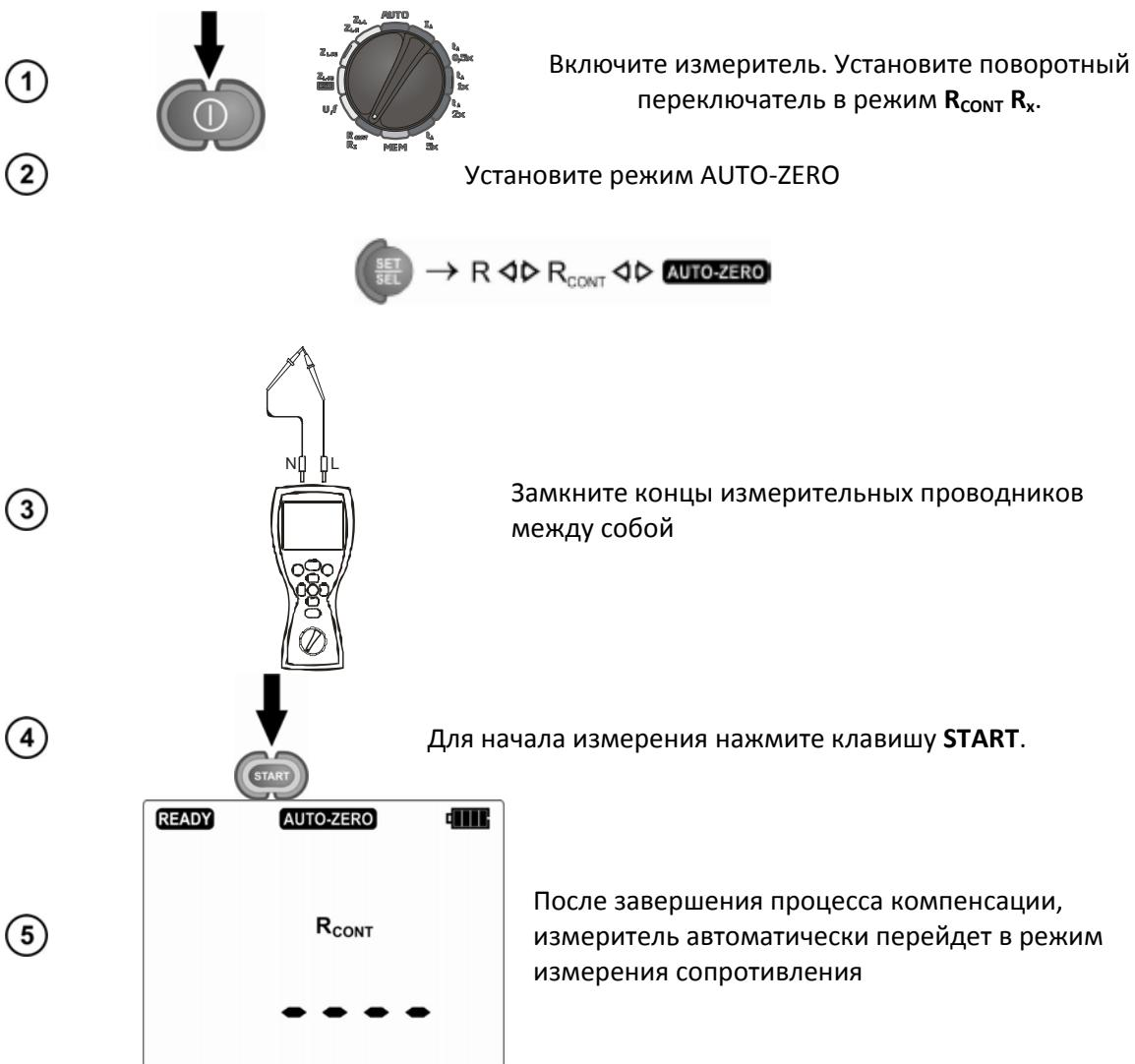
Надпись **AUTO-ZERO** остается на дисплее после перехода в один из режимов измерения сопротивления, что означает, что измерения проводятся с учетом компенсации сопротивления измерительных проводников.
