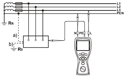
Остальные шаги совпадают с измерением параметров петли короткого замыкания L-PE
