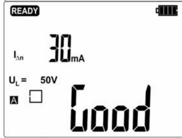
На основании проведенных измерений прибор делает заключение: **Good** - рабочее УЗО или **Bad** - нерабочее.
