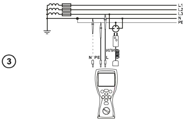
Подключите измеритель согласно схеме
