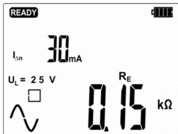
Сопротивление защитного заземления  $R_E$
