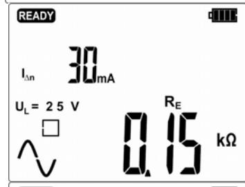
Сопротивление защитного заземления  $R_E$
