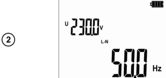
Результаты измерения: частота – на основной части экрана, напряжение - на вспомогательной.
