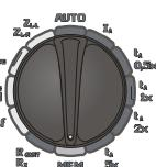
Включите измеритель. Установите поворотный переключатель в положение **MEM**.
