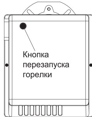
Рис. 12. Кнопка перезапуска горелки
