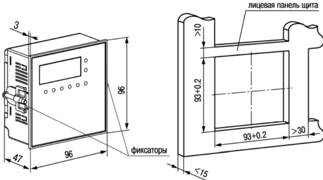
Рисунок А.5 – Прибор щитового крепления Щ11
