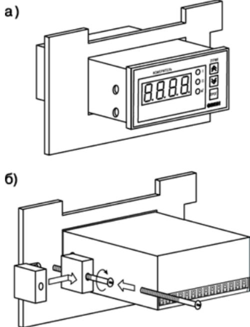
Рисунок 5.2 – Монтаж прибора щитового крепления
