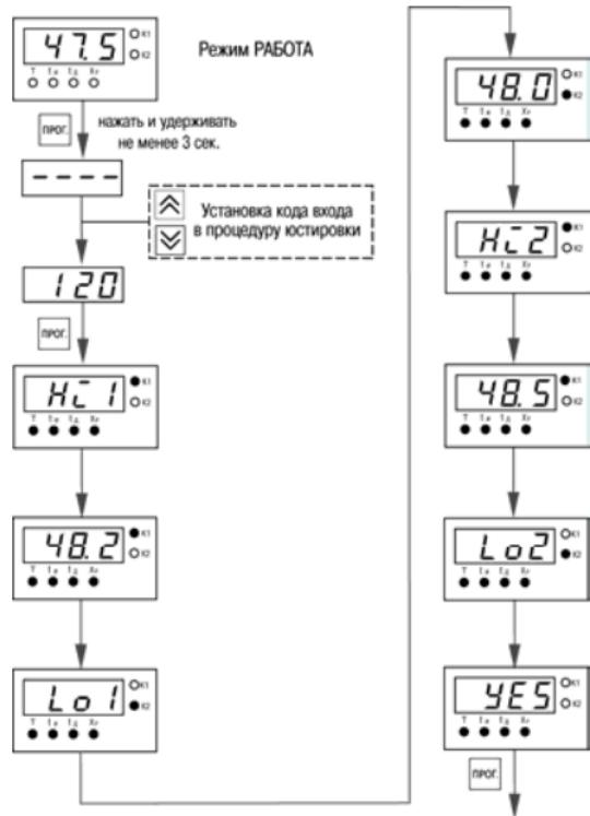
Рисунок Е.2 – Последовательность запуска и индикации АНР для TPM12-Щ1.Р
