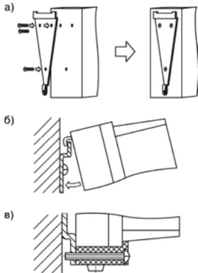
**Рисунок 5.1 – Монтаж прибора настенного исполнения**
