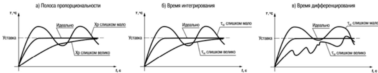
Рисунок 3.15 – Корректирование параметров регулирования
