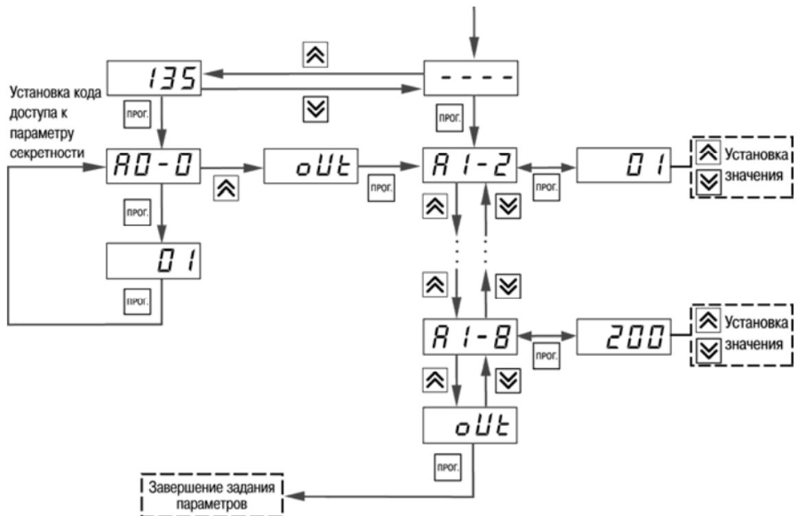
Рисунок 6.3 – Последовательность работы с прибором на втором уровне
