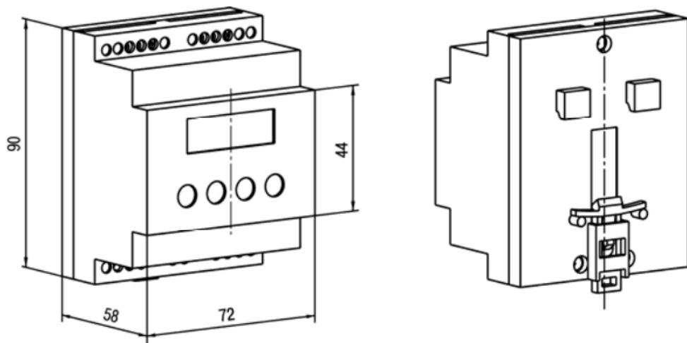
Рисунок А.4 – Прибор с креплением на DIN-рейку
