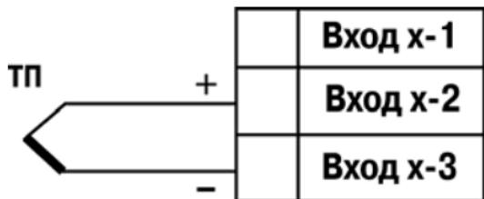
Рисунок Б.6 – Схема подключения термоэлектрического преобразователя
