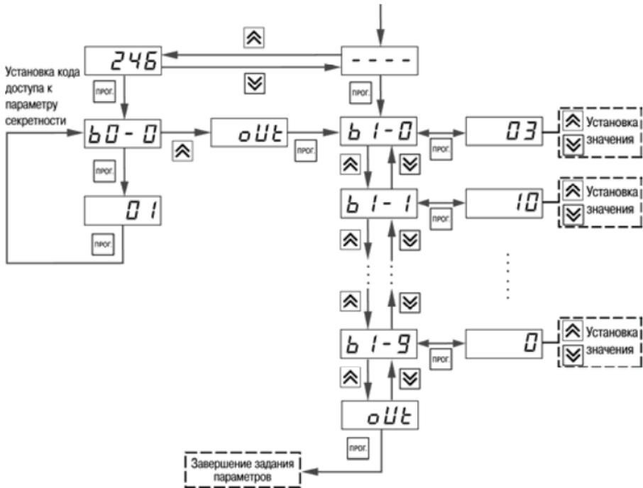
Рисунок 6.4 – Последовательность работы с прибором на втором уровне программирования (для группы параметров b)
