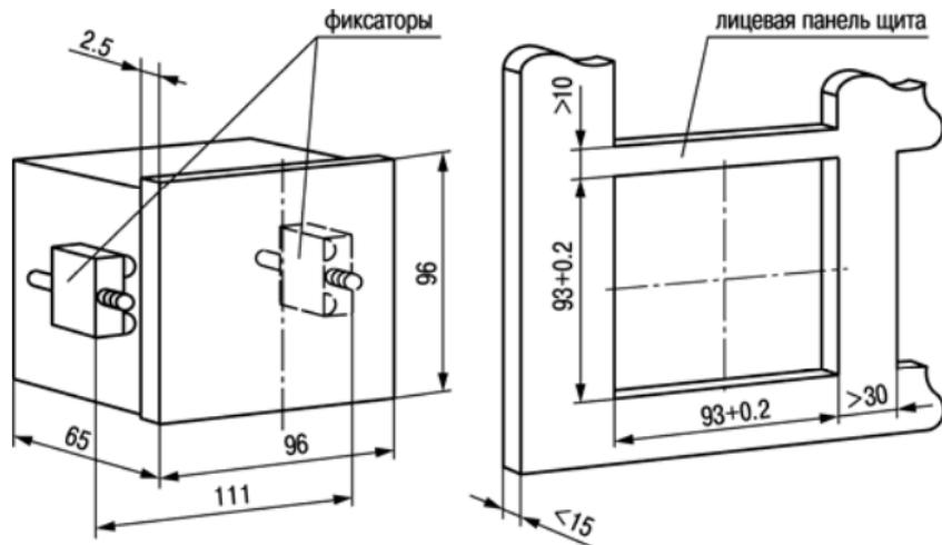
Рисунок А.2 – Прибор щитового крепления Щ1
