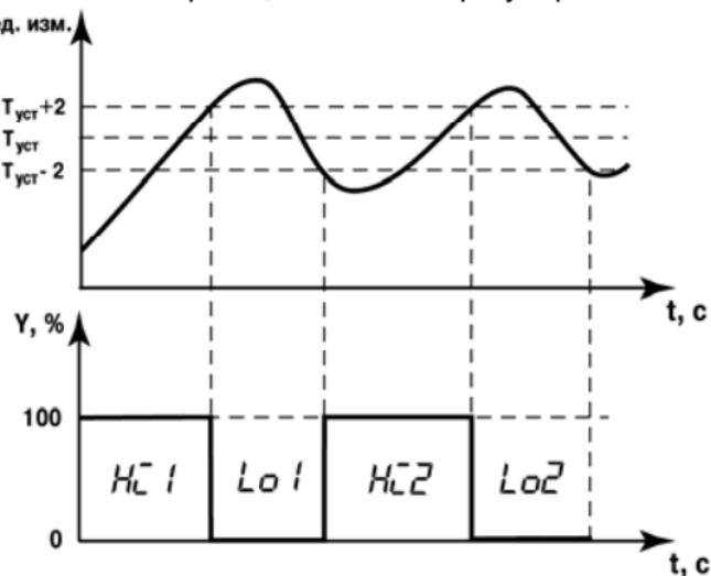
Рисунок Е.1 – АНР прибора, работающего в режиме нагревателя
