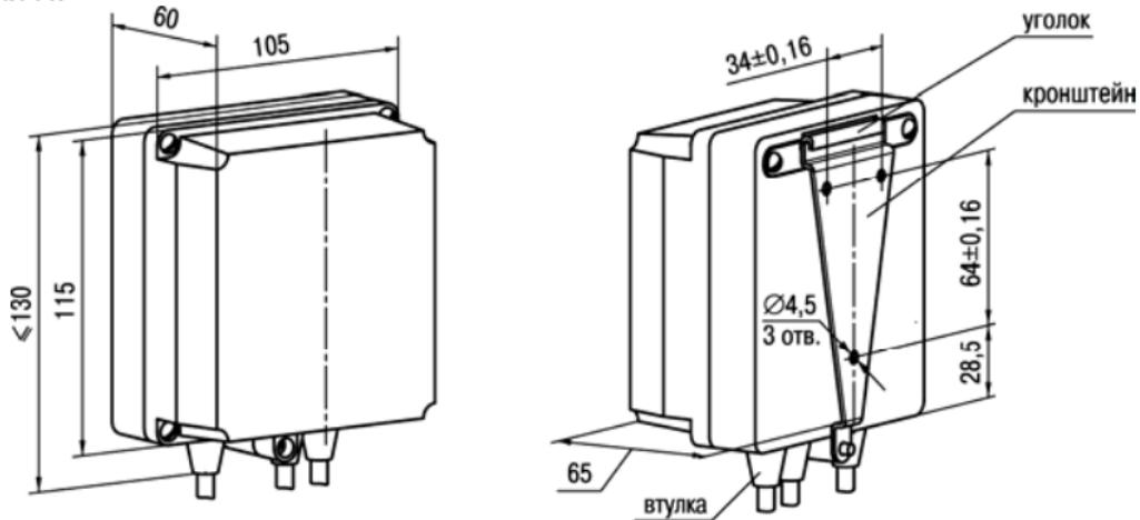
Рисунок А.1 – Прибор настенного крепления Н
