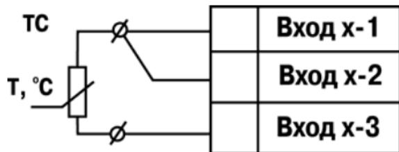
Рисунок Б.5 – Схема подключения термометра сопротивления
