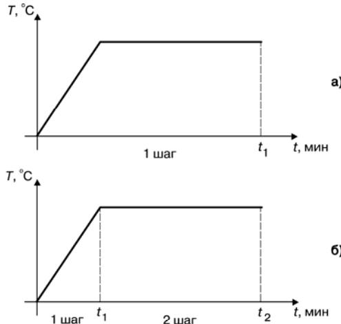
Рис. 6.1. Пример разбиения технологического режима на шаги:
