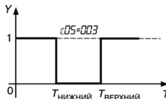
Рис. 3.17. Компаратор срабатывает вне установленных пределов
