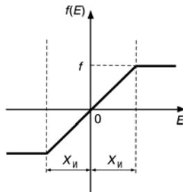
Рис. 3.9. Ограничение интегральной составляющей при помощи  $X_i$
