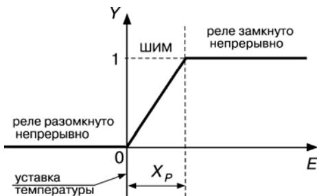
**Рис. 3.7. П-закон регулирования**
