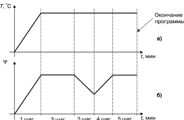
Рис. 6.2. Определение общего числа шагов в программе:
