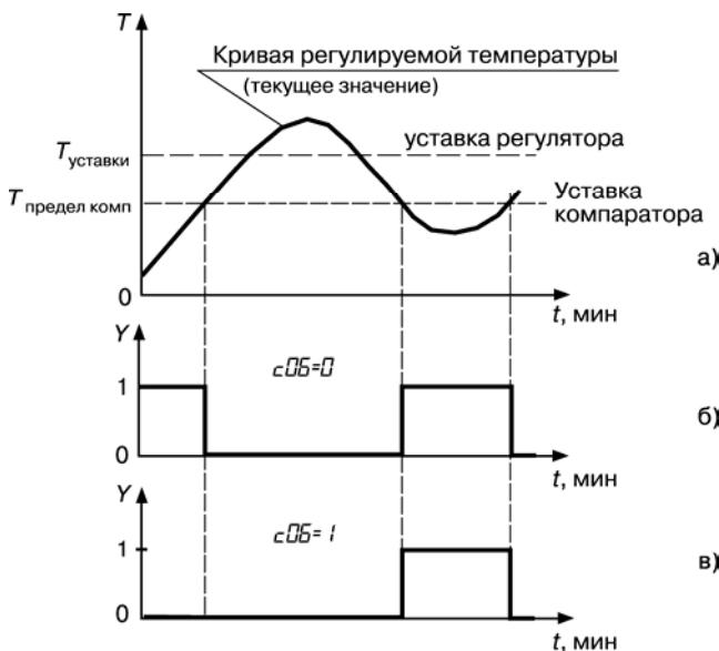
**Рис. 3.18. Блокировка срабатывания компаратора до 1-го достижения уставки**
