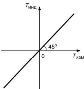
Рис. 3.3. Характеристика исправного датчика
