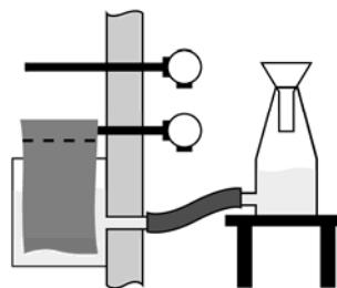
Рис. Е.4. Конструкция резервуара для воды, не требующая входления в камеру
