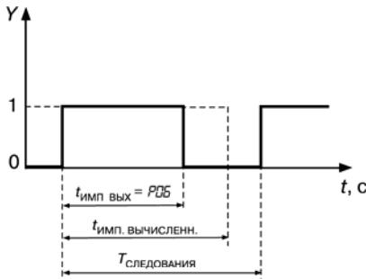
**Рис. 3.10. Ограничение максимальной мощности. Временная диаграмма**
