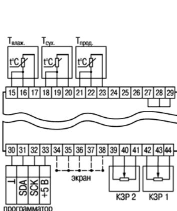
**Рис. Б.1. Подключение измерительных датчиков и датчиков положения задвижек**
