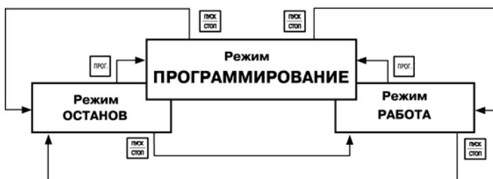
**Рис. 4.1. Режимы работы прибора**
