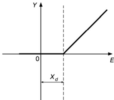
Рис. 3.12. Зона нечувствительности для исполнительного устройства типа "нагреватель"
