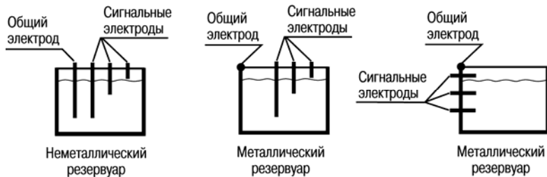
Рисунок 3.5 – Примеры установки кондуктометрических зондов
