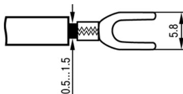
Рисунок 6.2 – Подготовка многожильного провода для монтажа с наконечником
