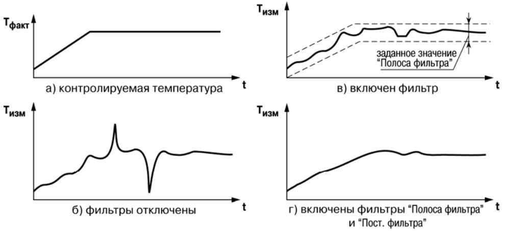
**Рисунок 4.2 – Временные диаграммы работы цифровых фильтров показаний датчика**
