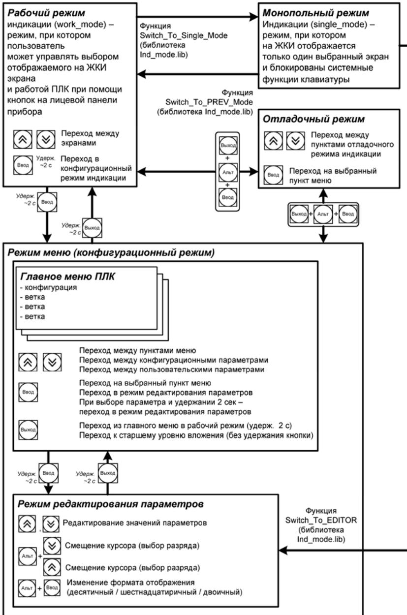
Рисунок 7.1 – Диаграмма переходов между режимами индикации ПЛК
