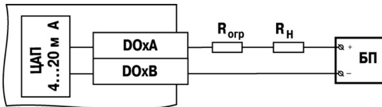
**Рисунок 3.3 – Схема подключения нагрузки к ВУ типа «И»**
