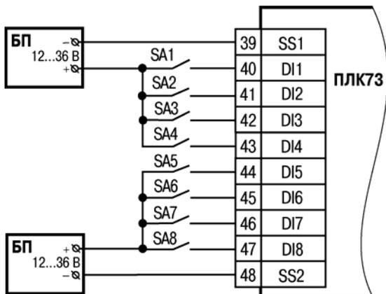
Рисунок Б.1 – Подключение датчиков к дискретным входам
