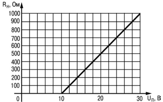
Рисунок 3.4 – График зависимости  $R_n$  ( $U_n$ )
