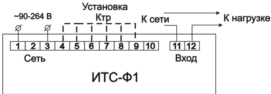
Рисунок Б.1 – Схема подключения прибора
