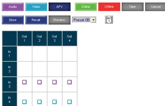
Рис. 23. Вызов предварительной настройки в режиме подтверждения Confirm
