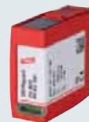
DG MOD PV SCI ...: защитный модуль для DEHNguard M YPV SCI ... с параллельной схемой включения варистора и короткозамыкающего устройства со встроенным предохранителем
