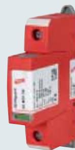
DG S WE 600 (FM): однополюсный штекерный ограничитель перенапряжений с расчетным напряжением варистора  $U_{mov} = 750$  В перем.тока, состоящий из базового элемента и вставного защитного модуля; дополнительно - с беспотенциальным контактом для дистанционной сигнализации
