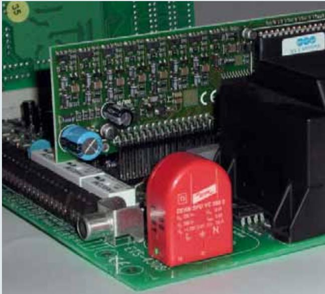
Для защиты электронного оборудования от импульсных перенапряжений. Для монтажа в корпусе защищаемого оборудования или непосредственно на защищаемом оборудовании. Имеется немецкий патент на прибор. Для применения согласно зонной концепции молниезащиты на границах МЗЗ 1-2 и выше.
