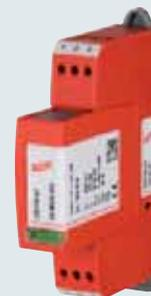
DR M 2P ... FM: двухполюсный ограничитель импульсных перенапряжений, состоящий из базового элемента и защитного сменного модуля; с беспотенциальным контактом для дистанционной сигнализации состояния
