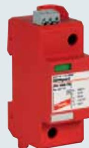
DG 1000 (FM): однополюсный компактный ограничитель импульсных перенапряжений с напряжением установки  $U_C = 1000$  В перем. тока; FM - исполнение с контактом для дистанционной сигнализации
