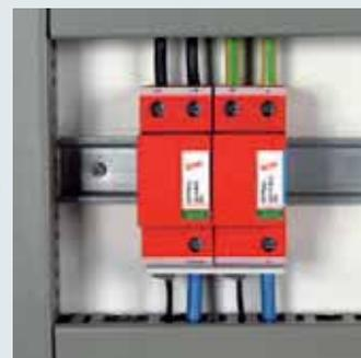
Разрядники DEHNbloc M имеют визуальную индикацию состояния защитных модулей. Состояние защитного модуля отображается на механическом индикаторе (зеленый цвет - рабочее состояние, красный - аварийное). Наряду с визуальной индикацией УЗИП DEHNbloc M...FM имеют контакт для дистанционной сигнализации состояния. Беспотенциальный переключающий контакт для дистанционной сигнализации состояния УЗИП в зависимости от концепции схемы может использоваться как размыкающий или замыкающий контакт.
