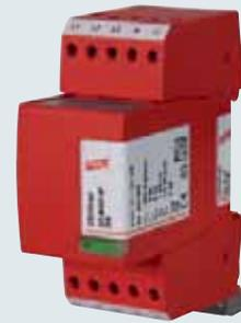
DR M 4P ... (FM): четырехполюсный ограничитель импульсных перенапряжений, состоящий из базового элемента, сменного защитного модуля; доступно исполнение с беспотенциальным контактом для дистанционной сигнализации состояния
