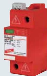
DG PV ... SCP FM: однополюсный ограничитель перенапряжений с комбинированным размыкающим и коротко замыкающим устройством для применения в фотогальванических установках с беспотенциальным переключающим контактом удаленной сигнализации
