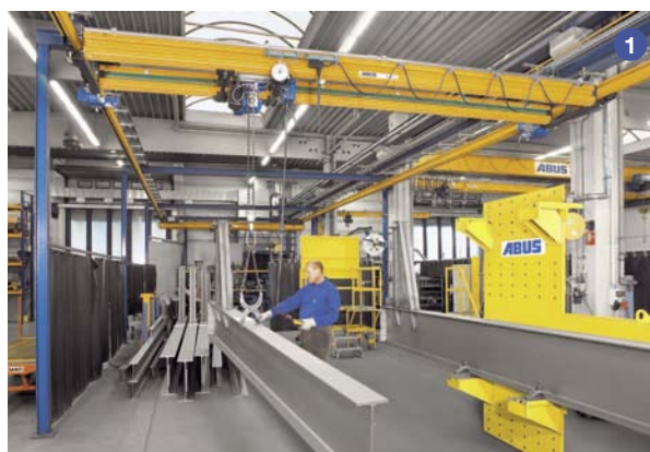
1 Укладка прокатных профилей с применением двойных подвесных путей типа ABUS ZHB
