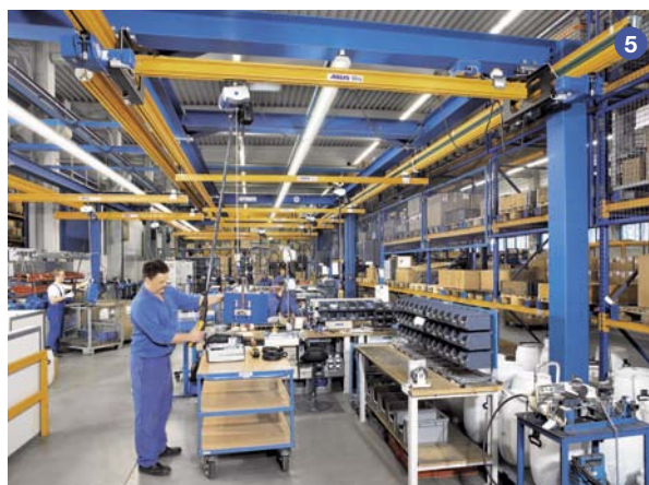
На производственной линии точное расположение деталей обеспечивается однобалочным подвесным краном типа ABUS EHB
