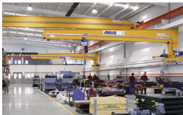
Однобалочный передвижной консольный кран типа ABUS EKL при перемещении сортового проката
