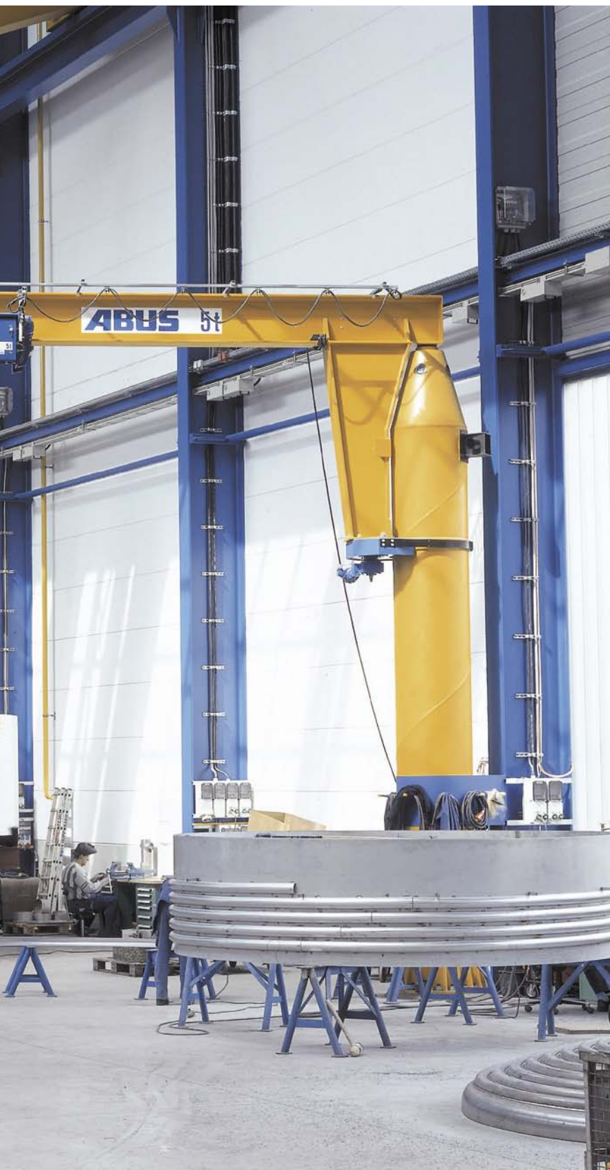
Кран консольный поворотный ABUS VS с электроуправлением при производстве котлов
