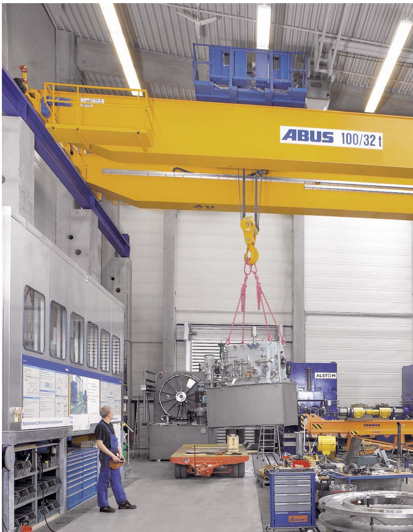
Двухбалочный передвижной кран типа ABUS ZLK, с двумя канатными тельферами при сборке на машиностроительном заводе
