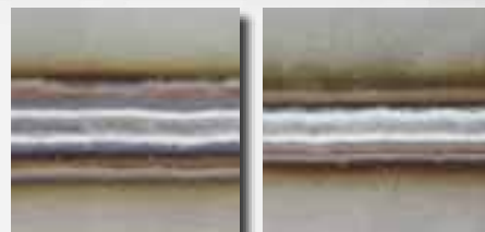
I-шов, CrNi t=1,5 мм, воздушный зазор=1,2 мм
