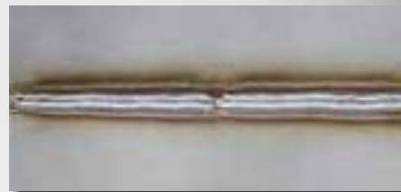
I-шов, CrNi t=0,8 мм, воздушный зазор=0,8 мм
