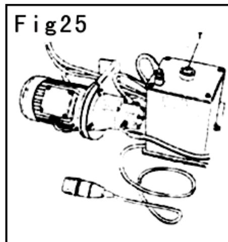
Проверьте натяжение ремней электрического мотора. При необходимости регулировки снимите защитную пластиковую крышку и отрегулируйте ремни с помощью регулировочного винта.
