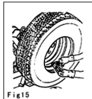
**Замечание: запрещается накачивать шину, пока она зафиксирована гидравлическим зажимным устройством. Процедура чрезвычайно опасна!**
