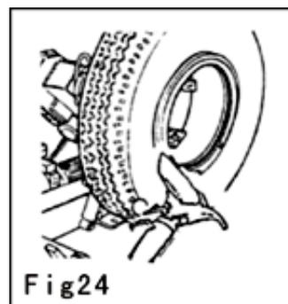
(6) Переведите инструментальную консоль в исходное положение, отпустите зажим и передвиньте платформу так, чтобы снять колесо с оси.
