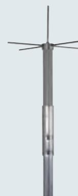
Трубостойка имеет цельную конструкцию, с алюминиевым молниеприёмным стержнем Ø 16/10 мм длиной 2500 мм.
