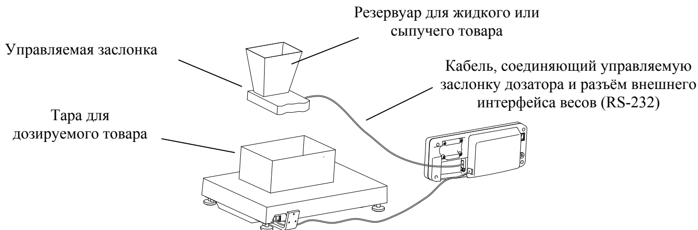
Рис. 7.2 - Подключение весов к дозирующему устройству
