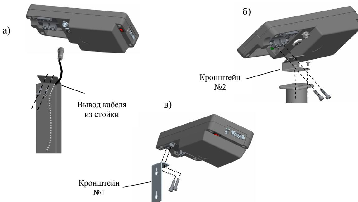
Рис. 4.2 - Варианты крепления терминала RA
