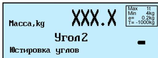
Снять гири с платформы.
