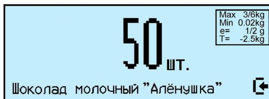
При использовании счетной функции допускается тарирование кнопкой **T** и предварительная установка тары, аналогично пп. 6.5.1.1, 6.5.1.2.
