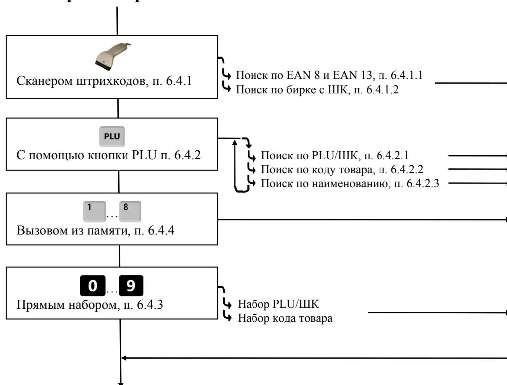
Рис. 6.3 - Структурная схема поиска товара в справочнике
