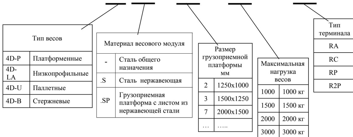
Весы поставляются в двух упаковках: модуль взвешивающий 4D\_ и терминал. В комплект поставки могут быть включены следующие опции: стойка, пандусы и рама для приямка.
