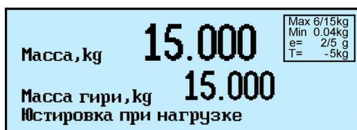
Примечание - Кнопку
