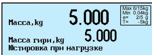
Юстировка при нагрузке завершена. Снять гири с платформы →
