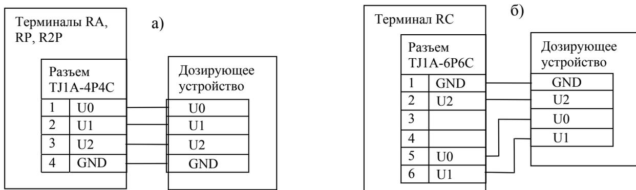
Рис. 5.2 - Выходные разъемы терминалов
