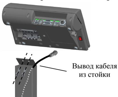
Рис. 4.4 Крепление терминала RC на стойке весов МК и ТВ
