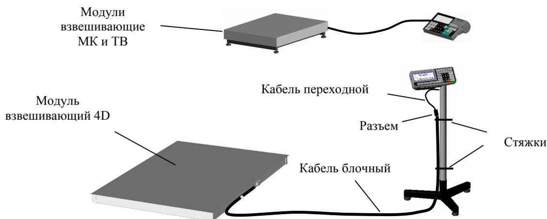
Рис. 5.1 - Подключение терминалов к модулям взвешивающим
