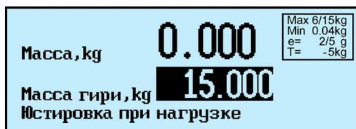
Где: **15.000** - означает, что максимальная нагрузка модуля (Max) составляет 15 кг. Для модулей с другими величинами максимальных нагрузок появится соответствующая индикация.
