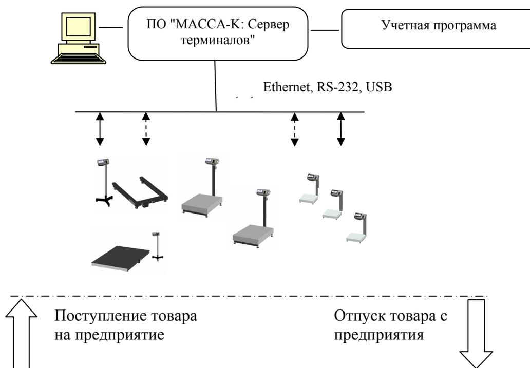
Рис. 1.1 - Схема функционирования весов с терминалами-регистраторами
