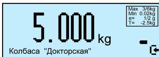
При ненагруженной платформе, индикатор должен показывать нулевую массу, в противном случае нажать кнопку установки нуля
