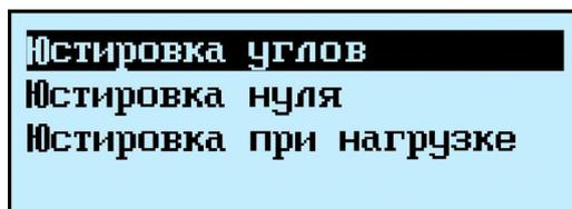
☞ Юстировка углов проводится после ремонта модуля (например, после замены весоизмерительного датчика и появления неравнозначности показаний весов при угловых нагрузках).
