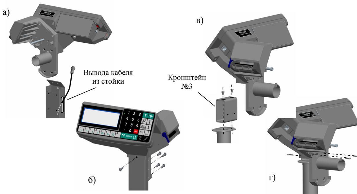
Рис. 4.8 - Варианты крепления терминалов RP и R2P
