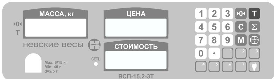
**Рис. 2. Панель передняя весов моделей ВСП-3ТК.**
