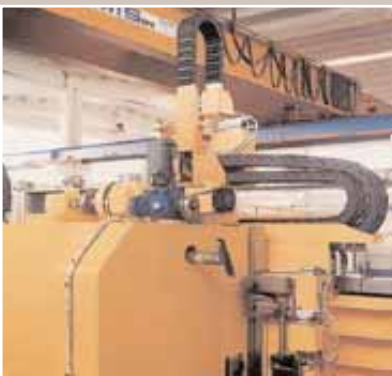
Macchina a controllo. Installazione di catene in orizzontale/verticale
