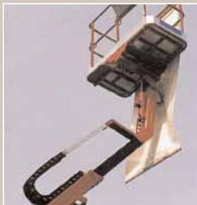
Piattaforma aerea. Installazione di catena portacavi Aerial platform. Installation of chains Hubplatte. Schleppketteneinbau
