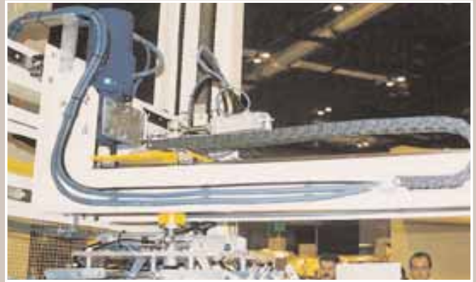
Impianto su robot su due assi - Catena portacavi LC 2700 Autoportanza - un punto essenziale grazie all'alta stabilità
