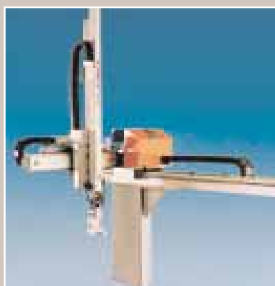
Robot. Installazione di tre catene portacavi Robot. Installation of three chains Roboter. Einbau von drei Schleppketten
