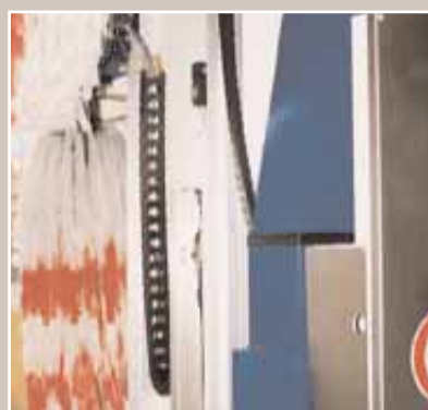
Impianto autolavaggio. Installazione di catena portacavi
