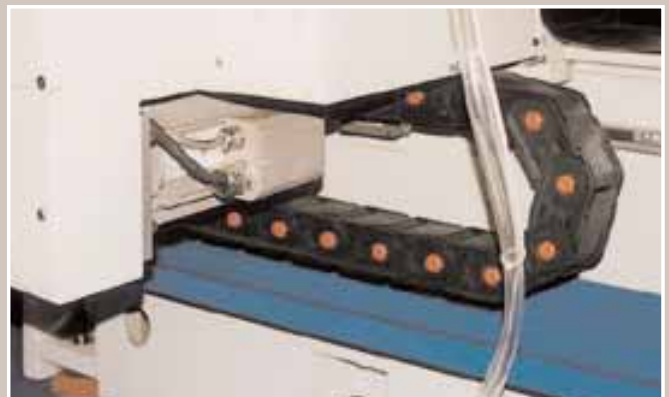
Macchina utensile a controllo - Catena portacavi chiusa LC 4300 C Un particolare che completa l'estetica di una macchina proiettata verso il futuro
