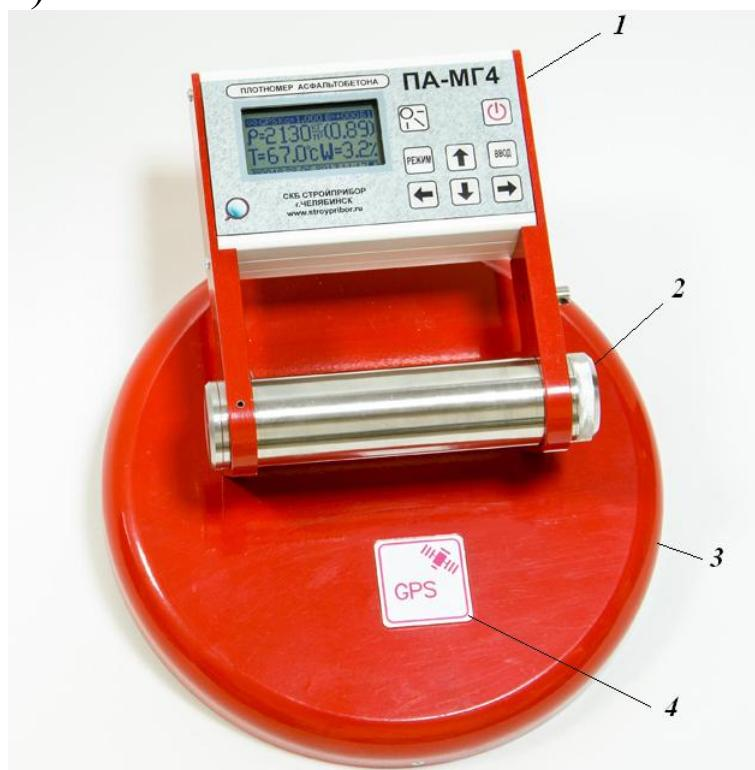
1 – электронный блок 2 – крышка батарейного отсека
