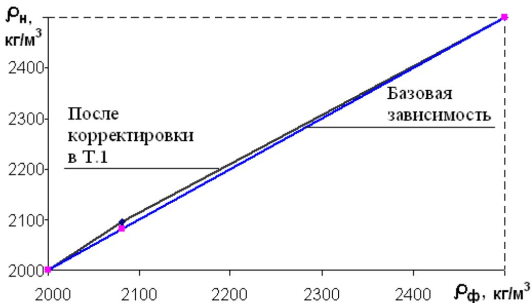
где  $\rho_H$  – средняя плотность асфальтобетона по показаниям плотномера,  $\text{кг}/\text{м}^3$ ;
