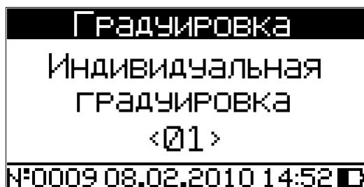
Кнопками ↓ (↑) установить требуемый номер индивидуальной градуировочной зависимости (от 1 до 9), например <01>, и нажать кнопку **ВВОД**. Дисплей плотномера примет следующий вид:
