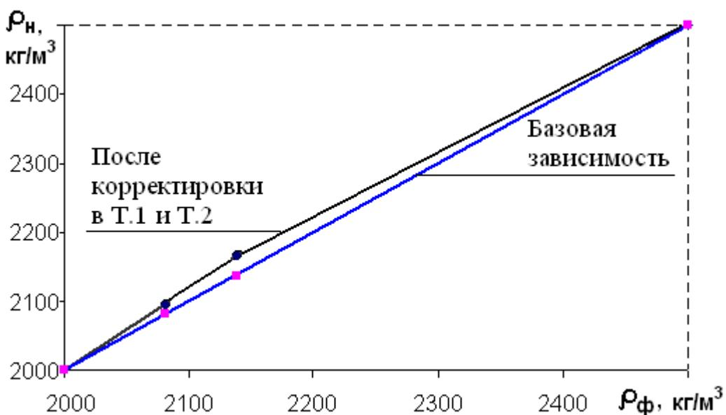
2.3.4.3 Плотномер позволяет провести корректировку базовой зависимости при количестве точек корректировки от 1 до 9 в диапазоне 1500...3500 кг/м<sup>3</sup>.
