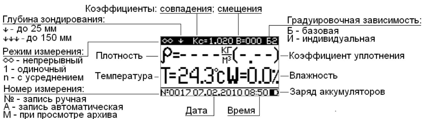
Рисунок 4 – Вид дисплея плотномера в процессе измерений
