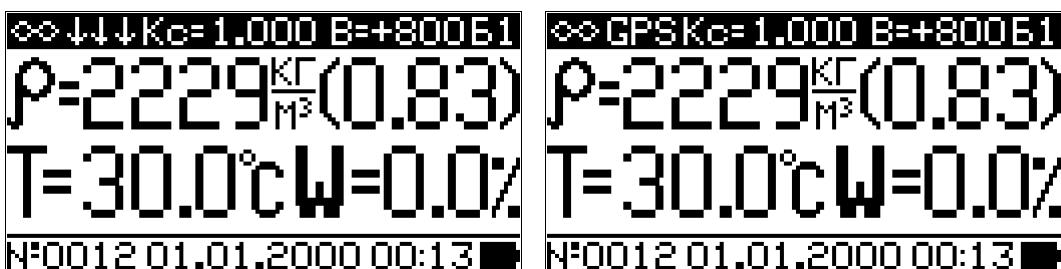
Если GPS включен, то при сохранении результатов измерений, в архиве сохраняются так же и координаты места измерений. При просмотре архива в верхней строке дисплея будет отображен значок GPS, например:
