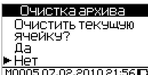
При помощи кнопок ↓ (↑) подтвердить или отменить действие по очистке архива и нажать **ВВОД**.
