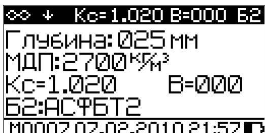
2.3.3.3 Если в ячейке архива сохранен результат измерений с усреднением, то на дисплее плотномера выводится среднее значение плотности и коэффициента уплотнения, например:
