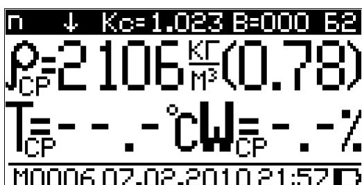
После нажатия кнопки **ВВОД** на дисплее плотномера выводятся параметры измерений. При повторном нажатии кнопки **ВВОД** на дисплей плотномера выводятся все промежуточные значения измеренной плотности, например:
