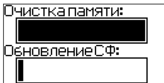
После окончания загрузки новых сервисных функций плотномер перейдет в режим связи с ПК.
