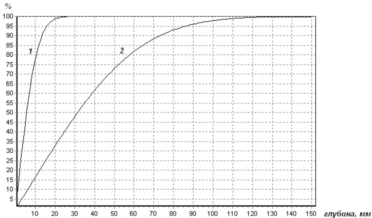
Рисунок 3 – Вклад толщины покрытия в измеряемую величину при различной глубине зондирования, при условии, что материал покрытия однороден
