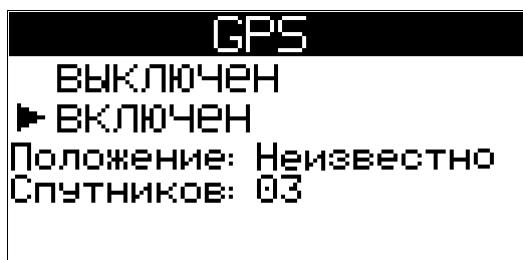
При первоначальном включении приемник GPS осуществляет поиск спутников. Этот процесс может занять не более десяти минут (в дальнейшем, при переноске плотномера, координаты места обновляются не реже двух секунд). После обнаружения спутников и приема от них сигналов определяются точные координаты места. Дисплей принимает вид, например:
