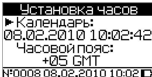
При необходимости изменения даты нажать **ВВОД**. Далее, по миганию активного параметра, при помощи кнопок ↓ (↑) установить число, месяц, год, часы, минуты и секунды для перехода между изменяемыми параметрами использовать кнопку **ВВОД**.
