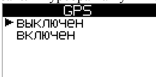
Для включения приемника GPS переместить указатель курсора на пункт «включен» и нажать ВВОД. Дисплей примет вид:
