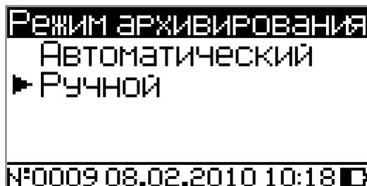
При помощи кнопок ↓ (↑) переместить курсор на требуемый режим записи результатов измерения в архив. Для подтверждения выбора нажать **ВВОД**. Для выхода из данного пункта настроек нажать **РЕЖИМ**.
