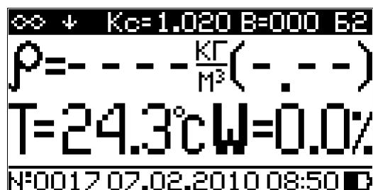
Условно дисплей плотномера разбит на три поля (рис.3): верхнее поле (инверсное) – параметры измерений; среднее поле (две строки) – поле результатов измерений; нижнее поле – строка статуса.
