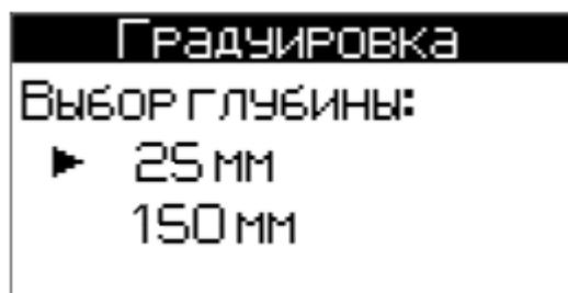
Так как плотность асфальтобетона измеряется в двух диапазонах зондирования глубины, то необходимо выбрать какой диапазон необходимо откорректировать. Установить курсор кнопками ↓ (↑) на требуемую глубину зондирования и нажать **ВВОД**. Дисплей плотномера примет вид, например:
