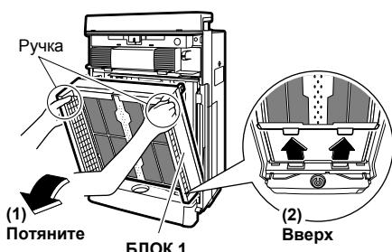
**4** Извлеките блок дезодорирующего катализатора.
