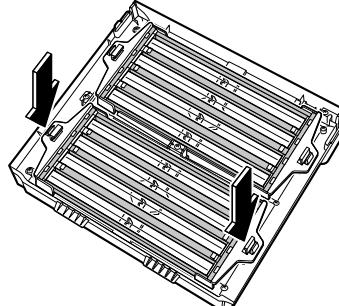
**2** Установите на место БЛОК 1 ►Стр. 31., предварительный фильтр, емкость с водой и переднюю панель. ►Стр. 29.
