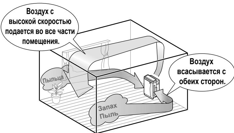
**Мощное всасывание при использовании высокой скорости воздушного потока позволяет захватывать пыль, пыльцу и т.п. Стремерный разряд расщепляет формальдегид и запахи.**
