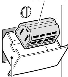
Используется для регенерации повторно используемого дезодорирующего картриджа.
