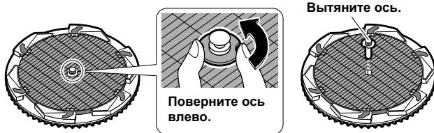
**4** Снимите увлажняющий фильтр с водяного колеса и прикрепите новый фильтр.
