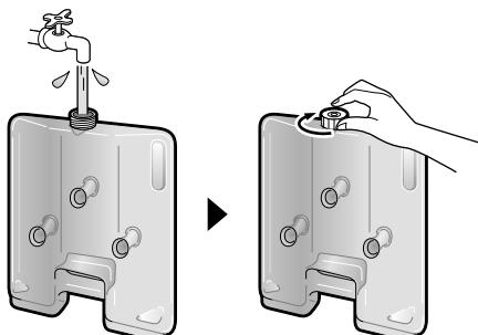
Плотно закройте пробку емкости с водой.
