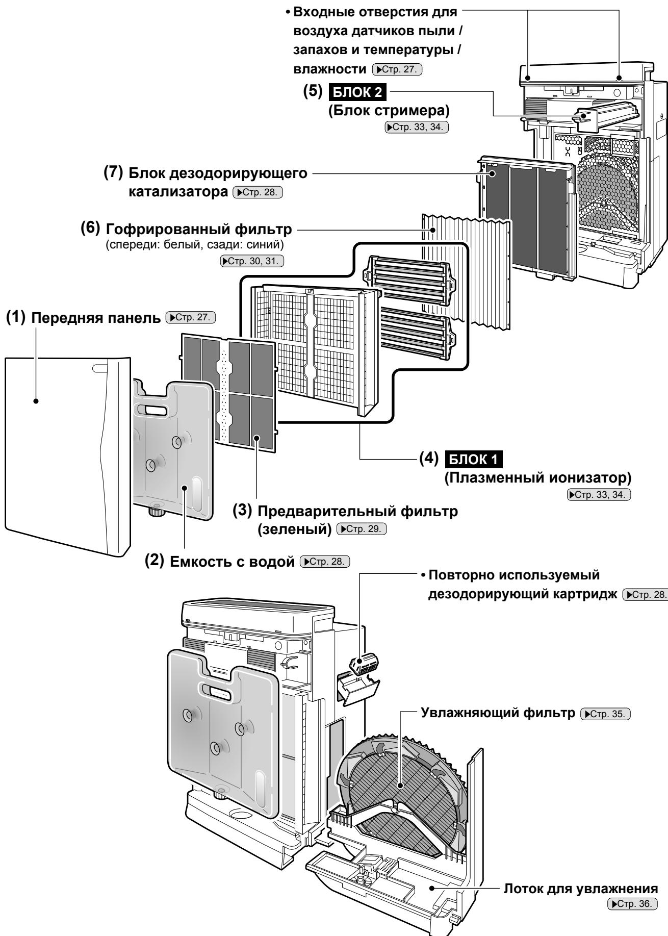
Для очистки лотка для увлажнения или увлажняющего фильтра, сначала отсоедините (1) переднюю панель и отсоедините (2) емкость с водой.
