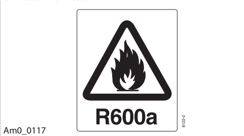
Рис. 6. Этикетка на компрессоре, работающем с хладагентом R600a
