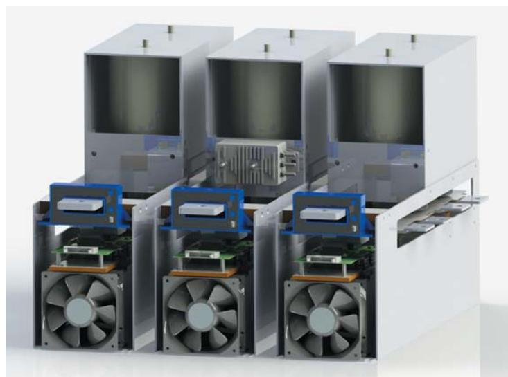
◀ Система шин внутренних связей обеспечивает легкость объединения блоков в трехфазный инвертор
