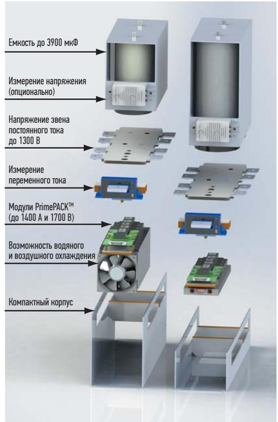
сочетается с семейством VARIS™ в неуправляемом, полууправляемом и полностью управляемом исполнении. На выбор также предлагается система воздушного или водяного охлаждения. В стандартном исполнении система может быть укомплектована блоком управления для
