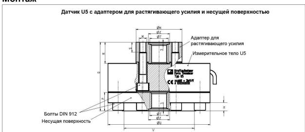
Вспомогательные детали для измерения усилий растяжения (адаптер для растягивающего усилия)
