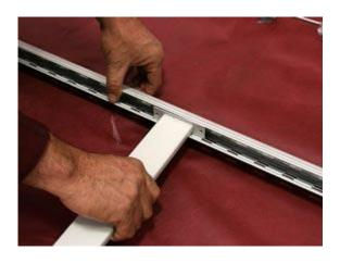
Сборка стеллажа начинается со сборки боковых рам. Заведите поперечину одним концом в первый паз стойки примерно посередине ее длины...
