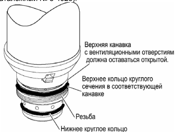
Круглое кольцо головки горелки
