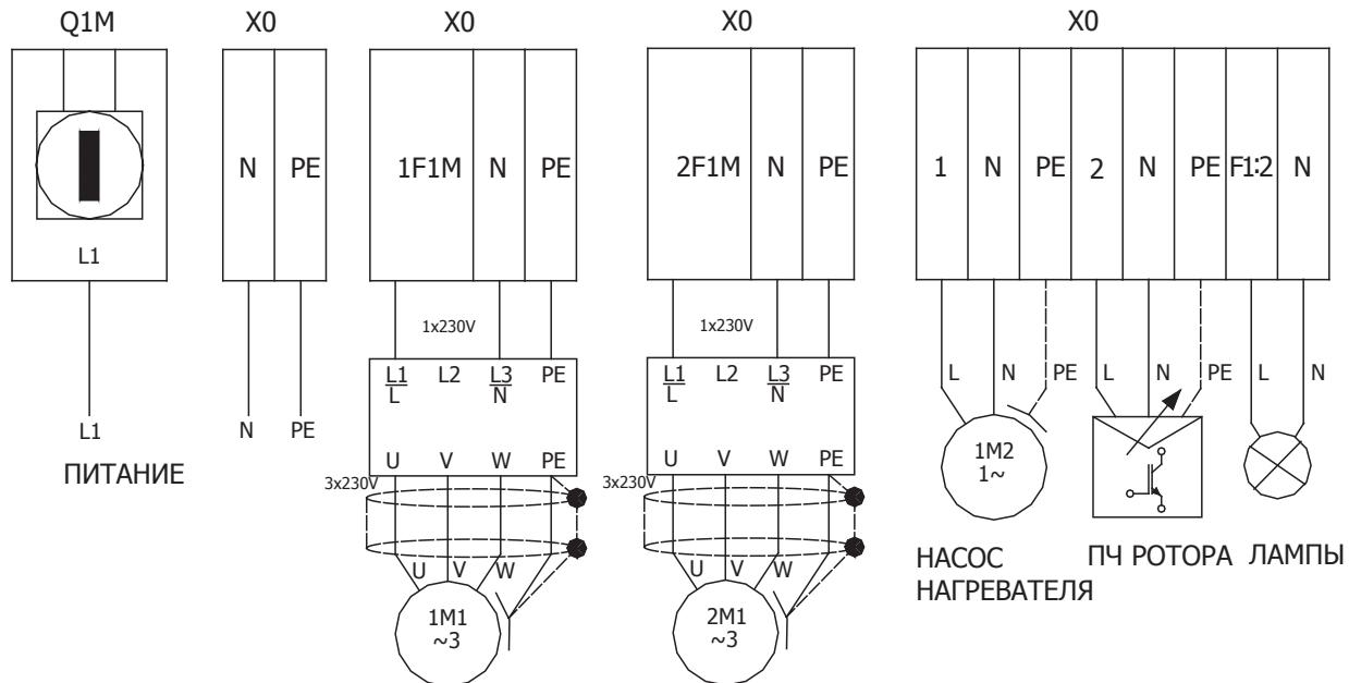
**Приложение 7 Принципиальная схема подключения питания и электродвигателя вентилятора для щитов управления VS 40-150 CG UPC SUP**
