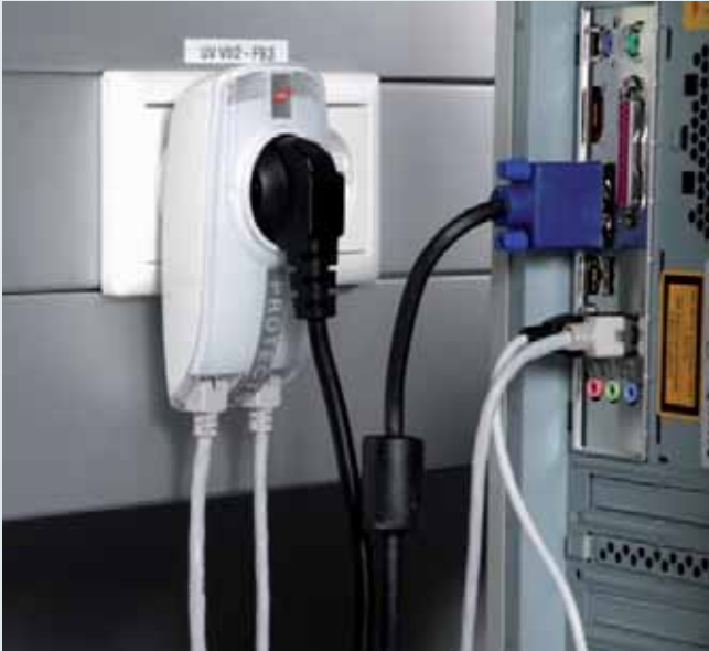
Комбинированный адаптер с УЗИП для установки в штепсельную розетку с заземляющим контактом и индикацией рабочего и аварийного состояния.
