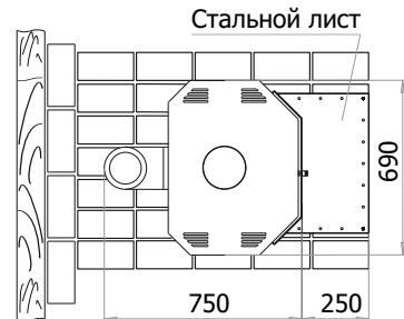
Рис. 2. Схема установки камина и монтаж дымохода
