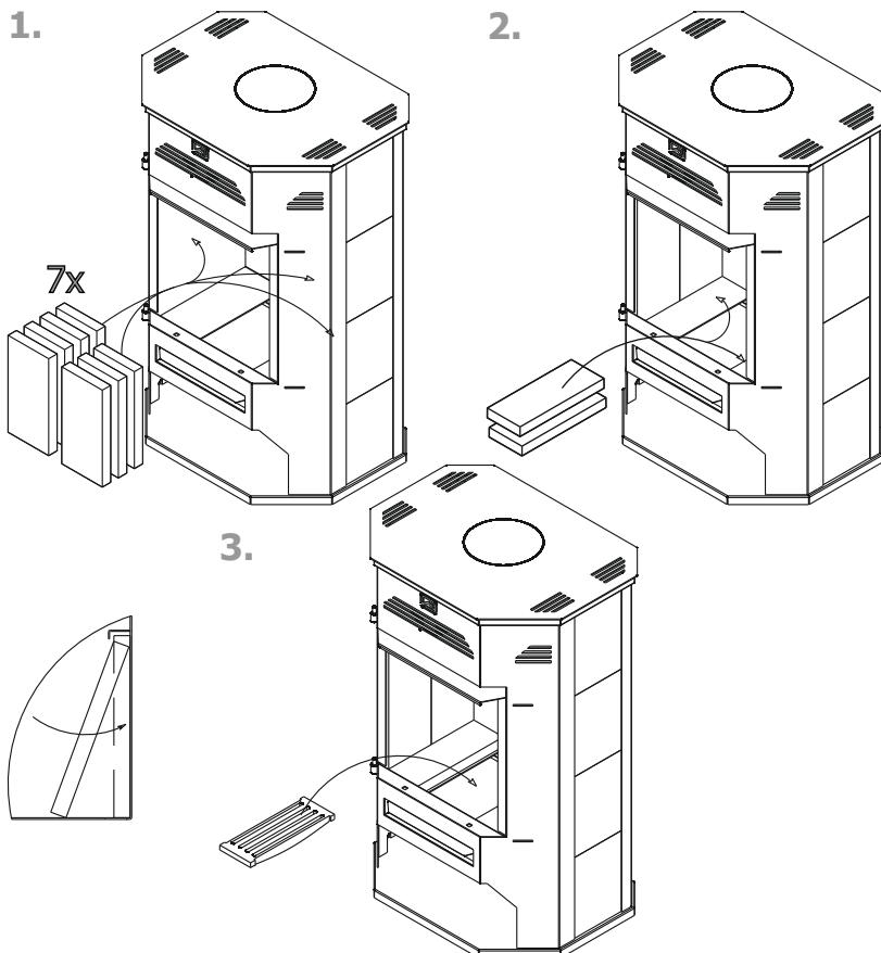
Рис. 3. Схема установки вермикулитовых плит и колосника
