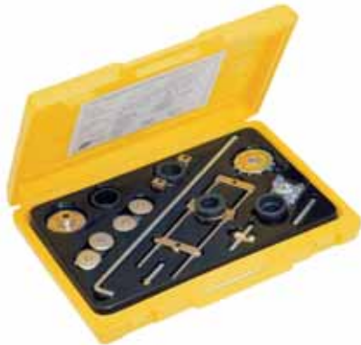
Люксовый набор горелок для круглых вырезов диаметром от 45 до 1060 мм. Середина крепится с помощью штырька, магнита или присоски. Также подходит для прямой резки.
