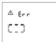
Измерительный инструмент имеет внутренний дефект и отключается через 5 с. Чтобы возвратить программное обеспечение в предыдущее состояние, извлеките батарейки, подождите несколько секунд и снова вставьте батарейки.
