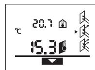
Чтобы перейти в режим теплового моста, нажмите кнопку режима теплового моста 10. На дисплее появляется индикатор j в качестве подтверждения.
