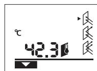
Чтобы перейти в режим температуры поверхности, нажмите кнопку режима температуры поверхности 11. На дисплее появляется индикатор k в качестве подтверждения.
