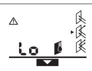
Температура поверхности объекта измерения в лазерном круге слишком высокая («**Hi**») или слишком низкая («**Lo**»). Температуру этого объекта измерить невозможно. Направьте лазерный круг на другой объект и начните новое измерение.
