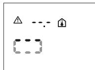
Температура окружающей среды слишком высокая или слишком низкая для работы измерительного инструмента. Измерительный инструмент выключается через 5 с, измерение в такой среде невозможно.
