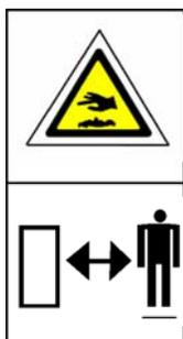
**Внимание.** Элемент находящийся под защитной оболочкой может иметь повышенную температуру. Соблюдай особенную осторожность в помещении котельной, другие элементы котла и оборудования также могут иметь повышенную температуру.
