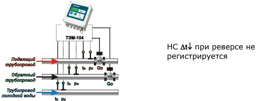
Схема «ОТКРЫТАЯ» позволяет вести учет тепловой энергии как при нормативных нагрузках в системе, так и в часы пиковых нагрузок (большой разбор теплоносителя), когда направление движения теплоносителя в обратном трубопроводе может измениться на реверсивное (к потребителю). При этом не требуется переустанавливать датчик расхода на обратном трубопроводе\*.
