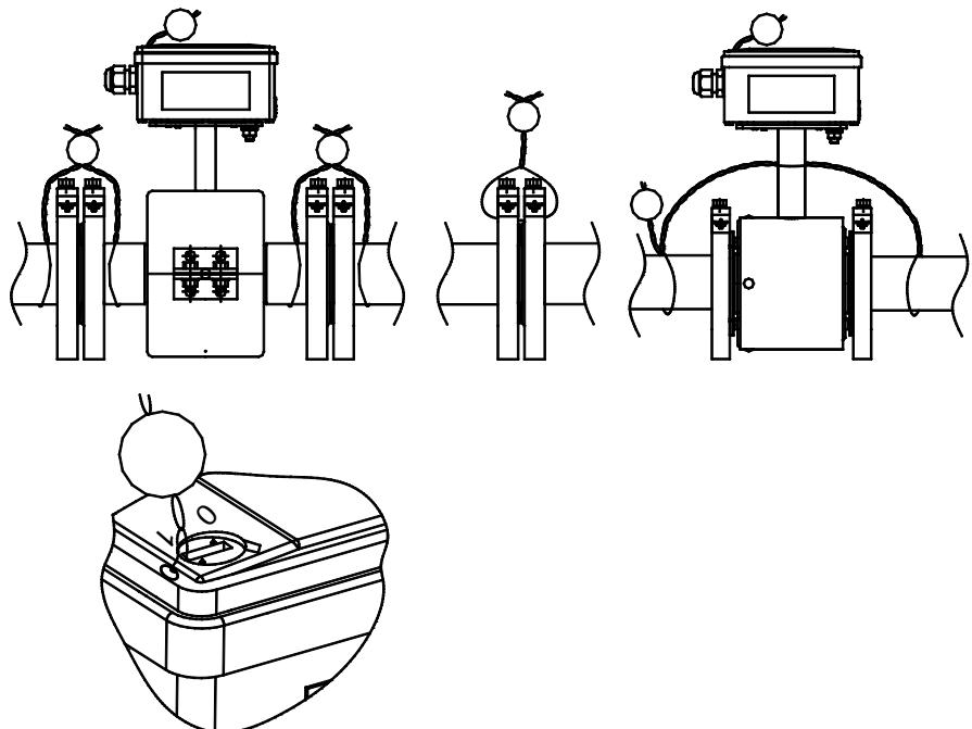
Пример пломбирования ИВБ
