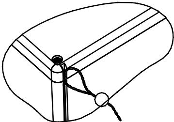
Пример пломбирования ТС на трубопроводе
