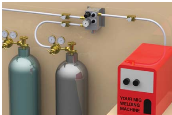
Настенный смеситель мини-PGM, чтобы доставить смешанные газы из отдельных газовых баллонов.
